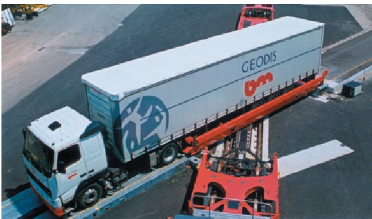
Abbildung 10: Seitliches Beladen eines neuartigen Waggons für die „rollende Landstrasse“, der ausgeschwenkt werden kann. (LOHR 2004)
