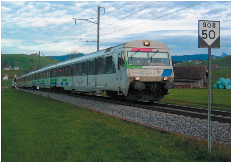
Abbildung 25: Der Voralpen- express verkehrt im integralen Taktfahrplan und überwindet hier bei Biberbrugg eine Steigung von 50‰, wenn nötig mit Schiebelok. (SUTER, 02.11.2005)
